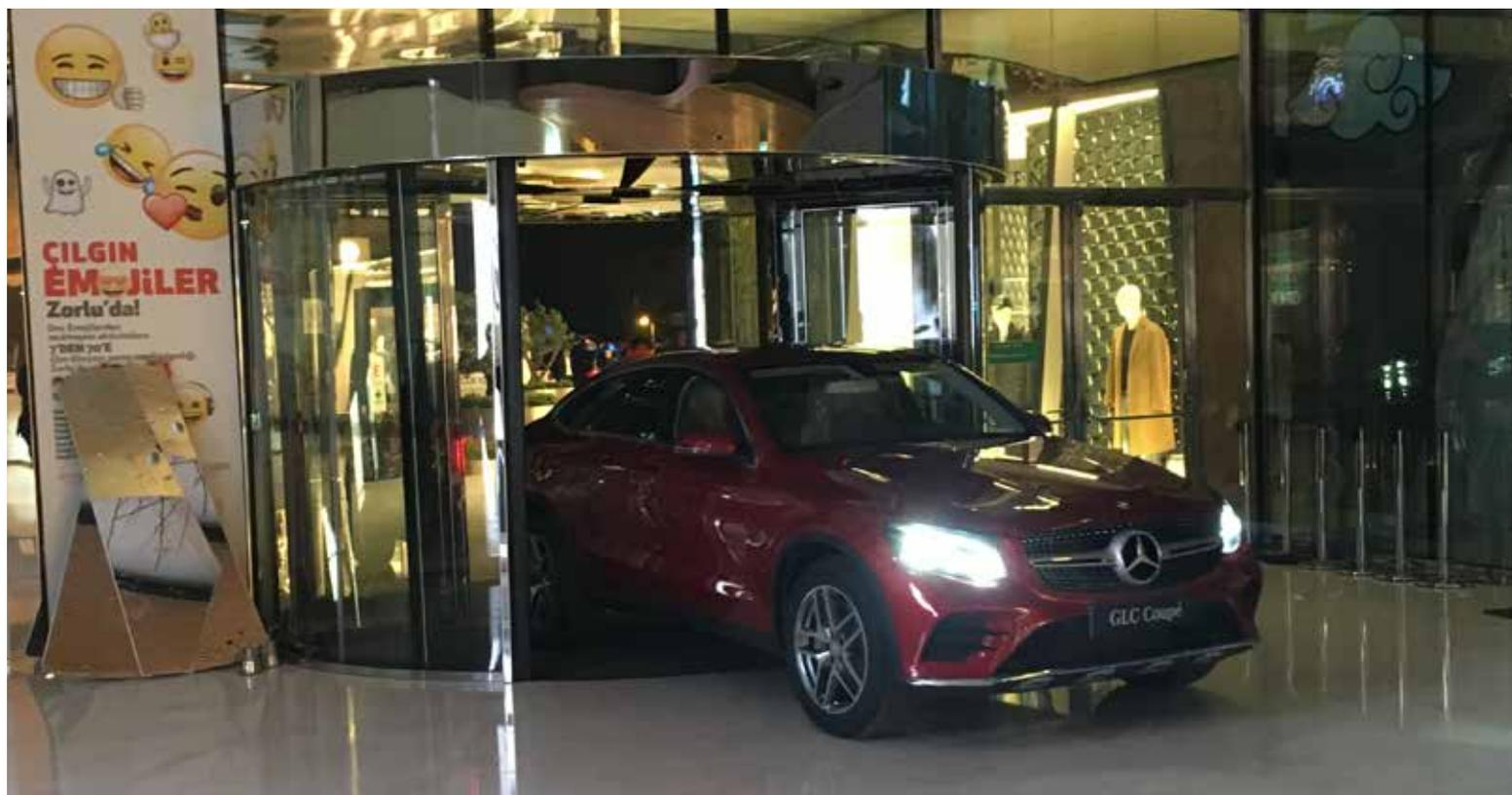
**METAXDOOR M-COM** ist für Eingänge konzipiert, bei denen andere Karusselltüren nicht ausreichen, um Lösungen anzubieten. Das System mit einer 2-flügeligen Konstruktion und einer in der Mitte angebrachten Schiebetür ermöglicht den Durchtritt sehr großer Objekte durch eine Karusselltür.
